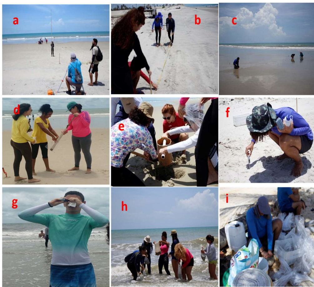
FIGURA 5: Imagens demonstrativas dos procedimentos do protocolo de coleta. a. perfil topográfico; b. medida da distância dos transectos; c. medida da largura da praia; d. coleta de amostra de sedimentos para granulometria; e. coleta de amostras de sedimentos para análise da macrofauna; f. medição da temperatura no sedimento superficial; g. medição da salinidade da água de percolação; h. lavagem das amostras biológicas; i. preservação das amostras com álcool etílico 70%).
