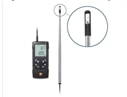
Figura 16 – Anemômetro de fio quente.
