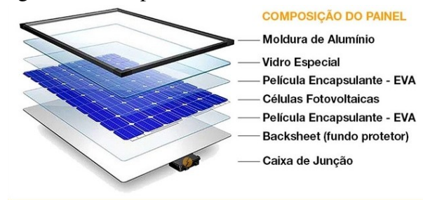
Figura 7 – Componentes do módulo fotovoltaico.
