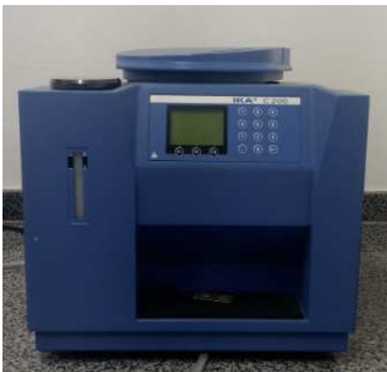
Figura 6 Calorímetro IKA C-200 em análise de poder calorimétrico.
