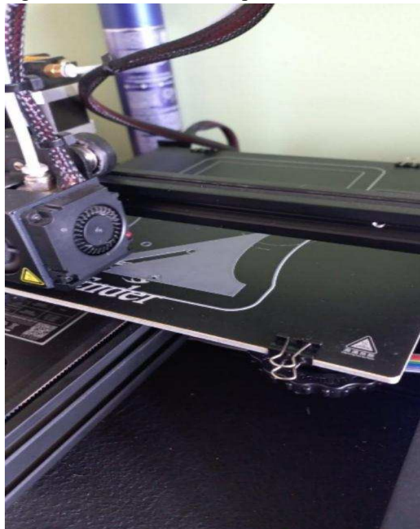
Figura 14 – Processo de impressão 3D do chassi
