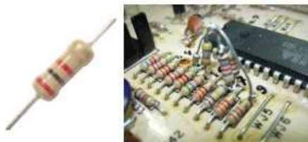
Figura 1: Imagem de um resistor; vários resistores compondo o circuito de um dispositivo eletrônico.
