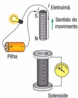
Figura 4.5: Movimentando-se um eletroímã com corrente elétrica próximo a um solenoide, como representado na figura, o galvanômetro indica a existência de corrente elétrica.
