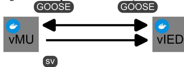
Figura 30 – Layout de comunicação IEC 61850 entre vIED e vMU
