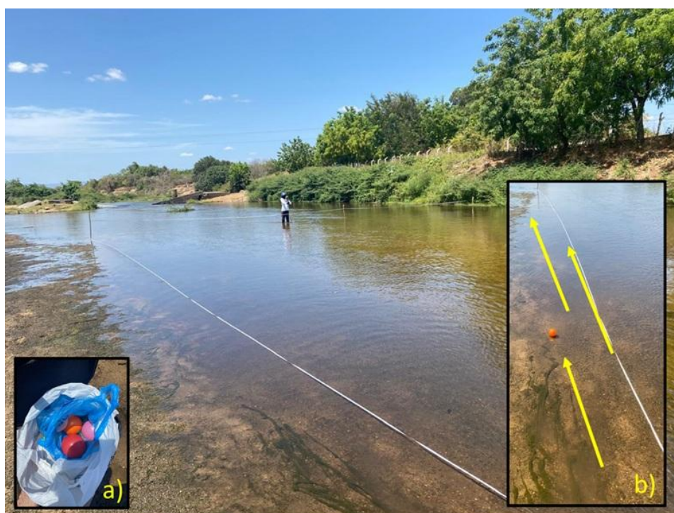
a) Flutuadores esféricos; b) Deslocamento das esferas flutuantes em distâncias predeterminadas.
