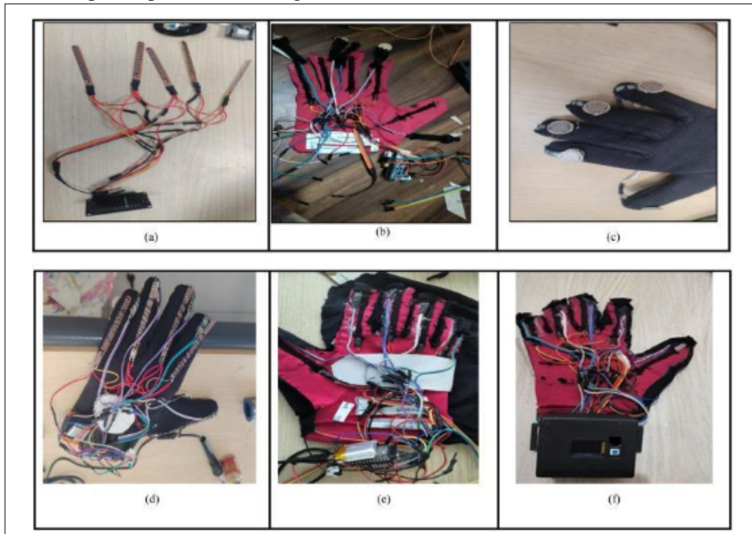
Figura 12 – Protótipo de luva inteligente, (a) circuito interconectado de 5 sensores flexíveis (b) circuito interconectado de 5 sensores flexi-força (c) fixa ambos os circuitos em conjunto em uma luva de algodão (d) circuito de interconexão com sensor Max30100, tela OLED e botão (e) conectar bateria lipo com versão anterior da tela OLED de correção cicuit (f) e botão com capa de tela impressa 3D na versão final do protótipo de luva inteligente.
