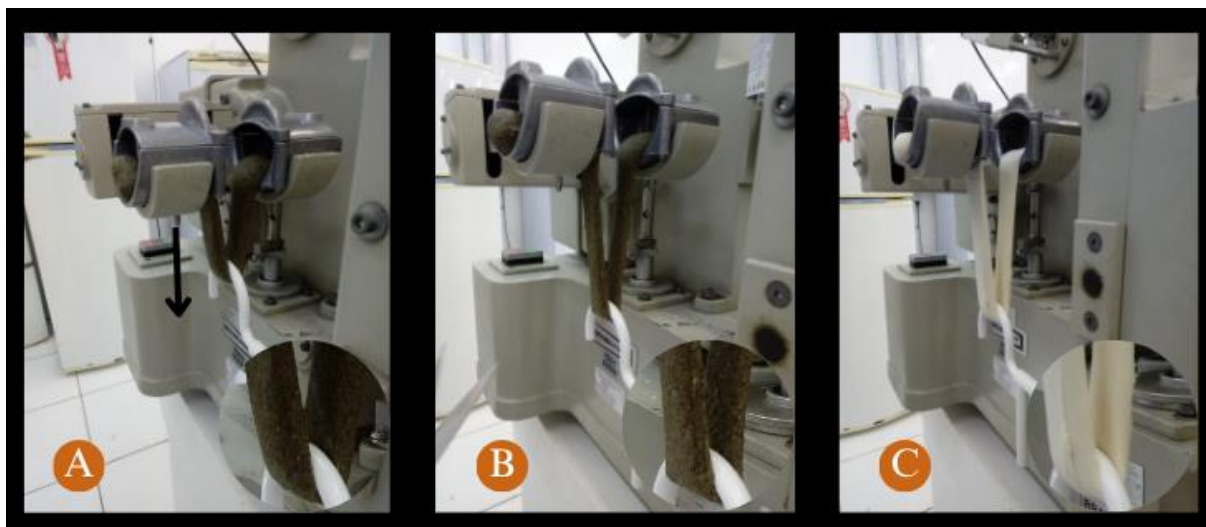
Figura 41 – Fotografias em fundo escuro mostrando o experimento com as massas realizado no extensógrafo
