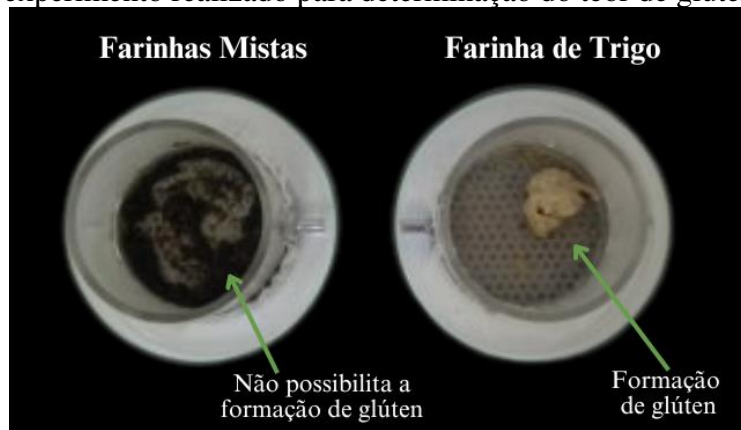
Figura 40 – Fotografia mostrando o resultado do experimento realizado para determinação do teor de glúten
