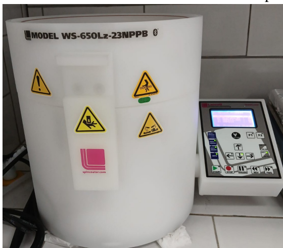
Figura 10 – Spin-coater modelo WS-650-23 da Laurell utilizado para a síntese dos filmes
