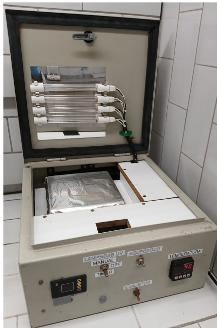
Figura 9 – Equipamento customizado utilizado para a limpeza de substratos sob plasma de ozônio
