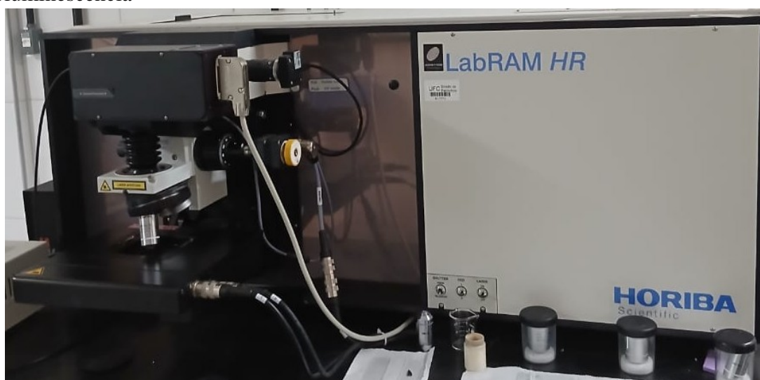
Figura 18 – Equipamento LabRAM HR da Horiba utilizado para obtenção das curvas de fotoluminescência
