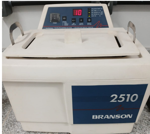
Figura 8 – Ultrasonic Cleaner 2510 da Branson utilizado para sonicação de substratos
