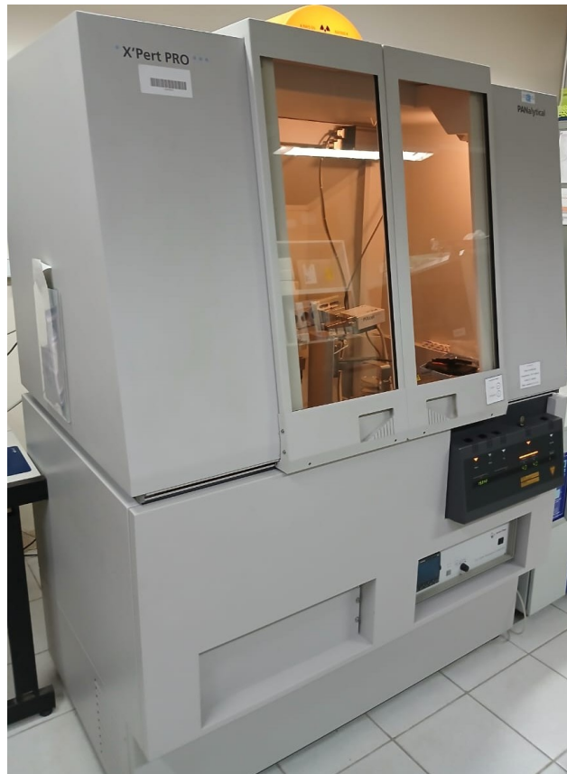
Figura 15 – Equipamento X'Pert PRO MPD da Malvern PANalytical utilizado para obtenção das curvas de DRX
