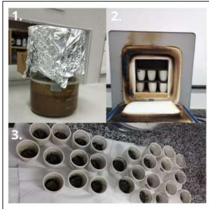
Figura 7 - Etapas do processo de produção do carvão ativado: (1) preparo da amostra com o agente ativante; (2) carbonização do material em mufla, utilizando cadinhos de 30 mL; (3) carvão ativado após o processo de carbonização.
