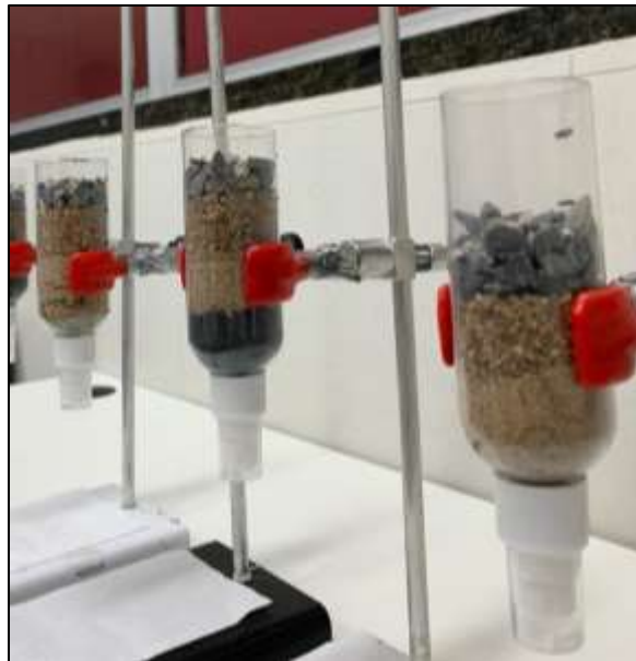
Figura 9 - Protótipo do biofiltro composto por brita 0, areia grossa, areia fina e carvão ativado.
