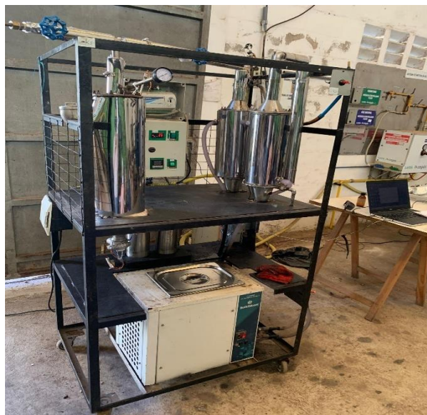
Figura 8 - Unidade de pirólise do LCE+/UECE
