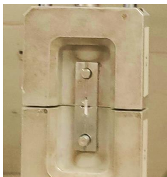
Figura 4. Corpo de prova acoplado ao dispositivo na máquina de ensaio
