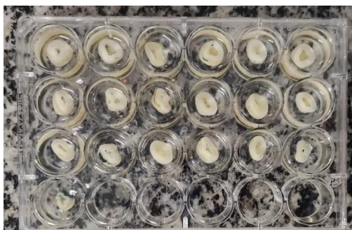
Figura 2. Espécimes dos grupos 03 e 04 em ácido láctico a 0,1M.
