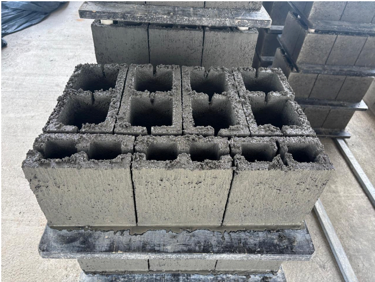
Figura 13 - Bloco de concreto de vedação recém moldado, com detalhe para porções da mistura de concreto com consistência seca junto ao bloco.
