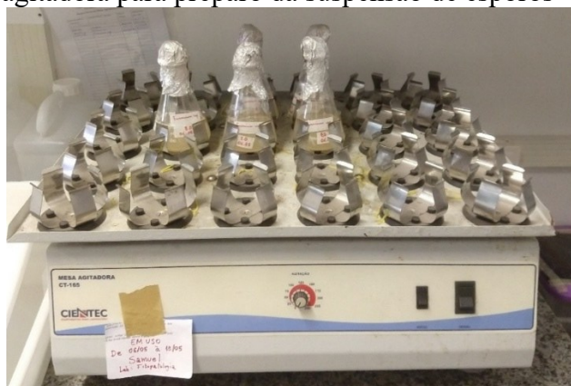
Figura 4 – Frascos Erlenmeyer em mesa agitadora para preparo da suspensão de esporos
