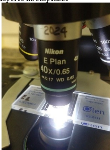
Figura 5 – Microscópio óptico e câmara de Neubauer utilizados na determinação da concentração de esporos na suspensão
