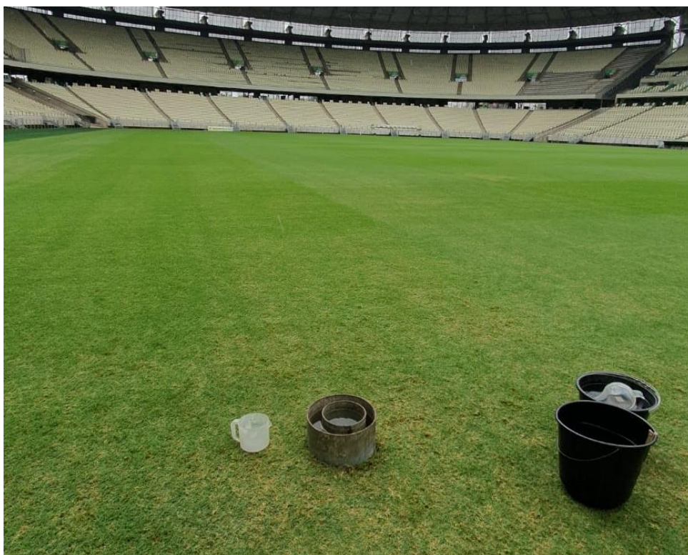
Figura 6 - Instalação dos cilindros para teste de infiltração.
