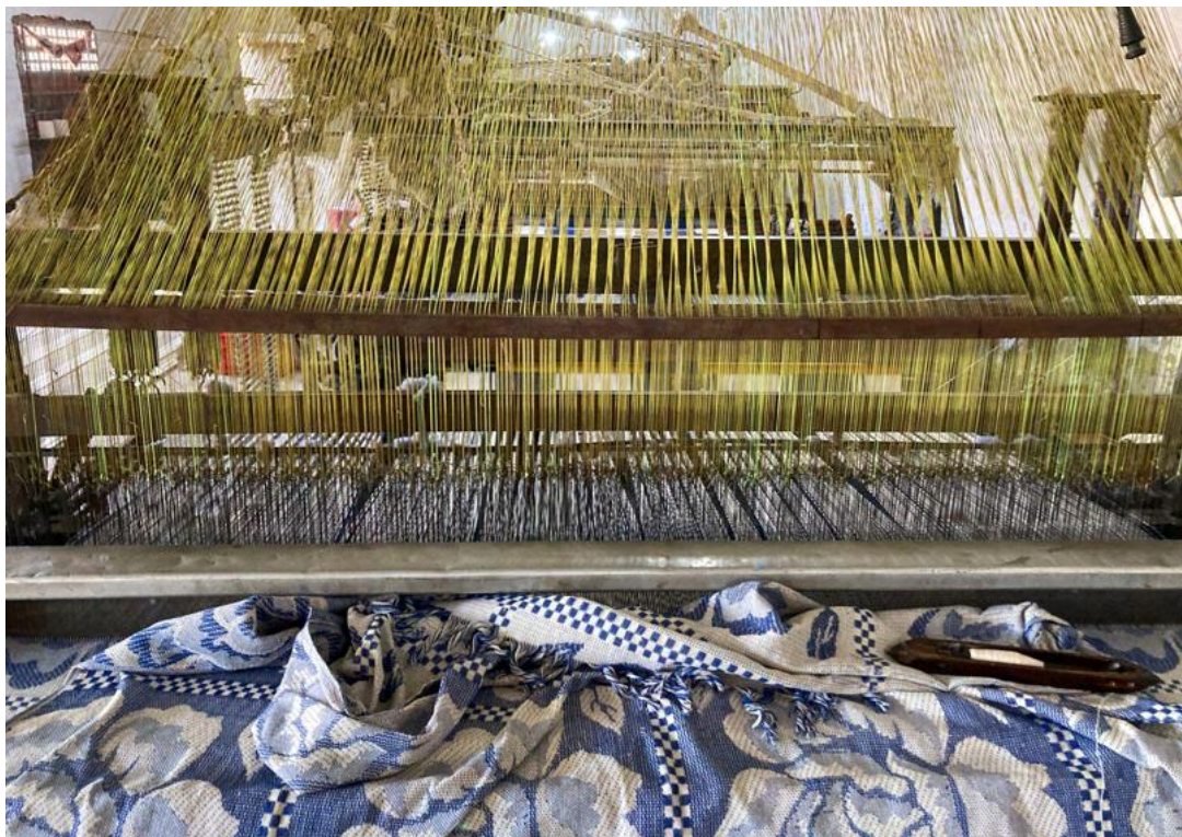
Figura 50 - Detalhe do Sistema de tecelagem da Trama em Tear Jacquard | Fonte: Autoria Própria (2025)
