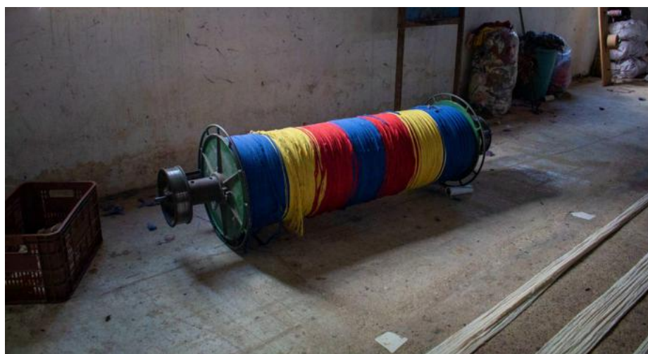
Figura 32 - Orgão cheio com camada de fio completa | Fonte: Autoria Própria (2024)
