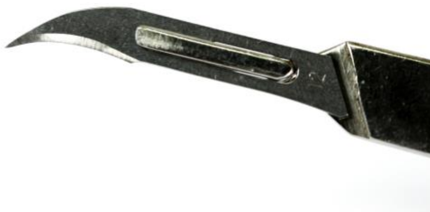
Figura 5.32 - Lâmina de bisturi Nº 12, utilizado para remover grandes excessos de resina composta, entretanto deve ser usado com cuidado para não causar acidentes.
