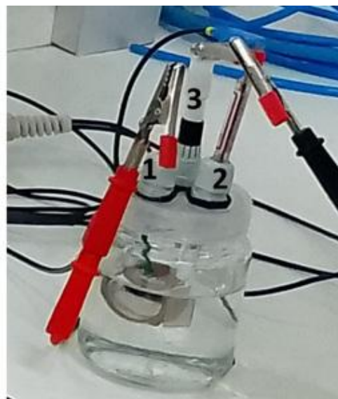
Figura 17 – Estrutura da célula eletrolítica a) Representação esquemática; b) Imagem real, mostrando a posição dos eletrodos 1. de trabalho, 2. contra-eletródo e 3. de referência.
