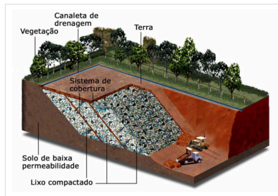
Figura 04 - Método construtivo rampa
