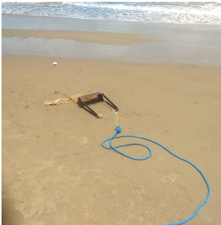
Figura 8. Draga biológica de arrasto utilizada nas amostragens em praia.
