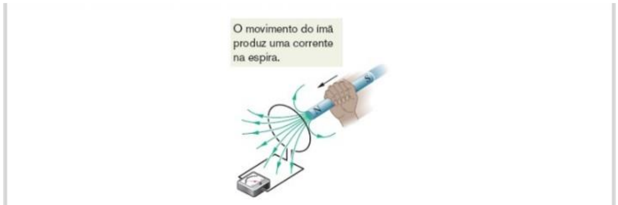
Figura 8- Corrente induzida pelo movimento de um ímã através de uma espira
