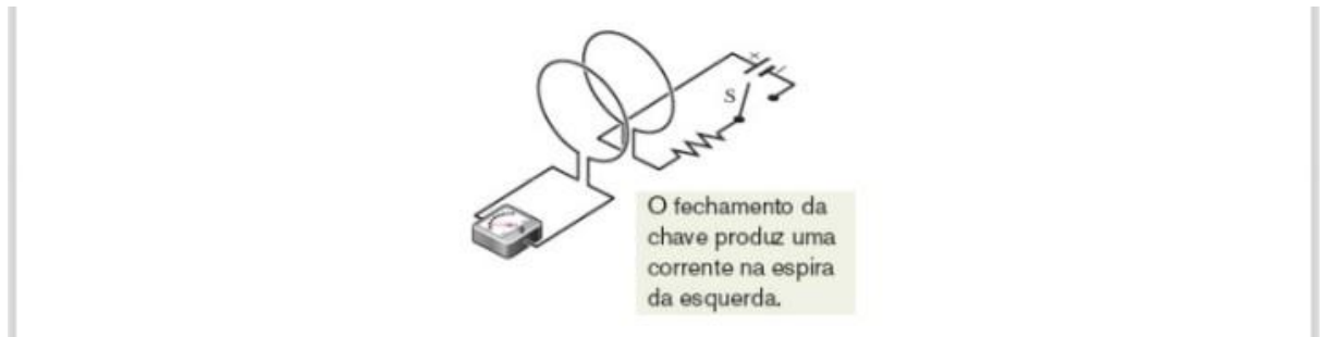
Figura 9- Corrente induzida pelo fechamento do circuito em uma espira próxima
