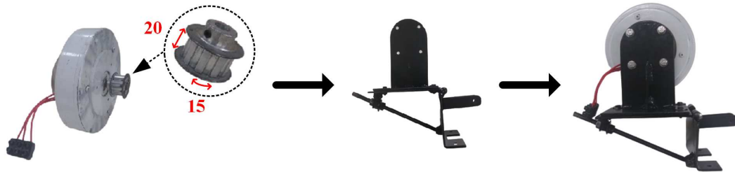
Figura 5 – Acoplamento da polia do gerador e montagem na base construída, unidades em milímetros.
