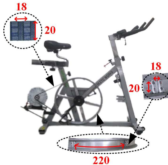
Figura 6 – Detalhe da correia dentada e dos dentes adicionados a polia dos pedais, unidades em milímetros.
