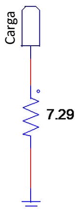
Figura 56 – Modelo resistivo da bateria.
