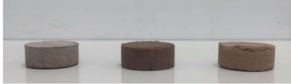
Figura 12 - Amostras de cinza têxtil, solo e mistura solo/cinza têxtil
