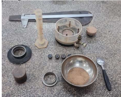
Figura 9 - Aparelhagem utilizada o para o ensaio de adensamento
