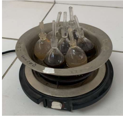
Figura 5 - Picnômetros utilizados no ensaio de densidade real
