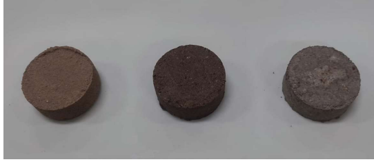
Figura 11 - Amostras após o ensaio de adensamento
