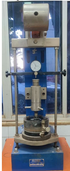
Figura 10 - Aparelho de adensamento
