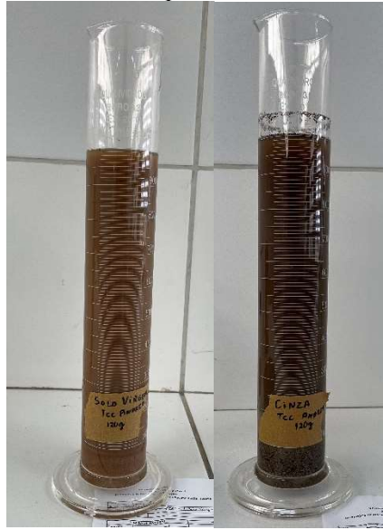
Figura 7 - Provetas utilizadas no processo de sedimentação das amostras
