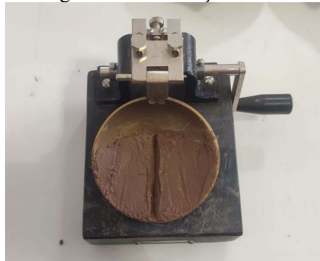
Figura 4 - Aparelho de Casagrande na realização do ensaio de Limite de Liquidez
