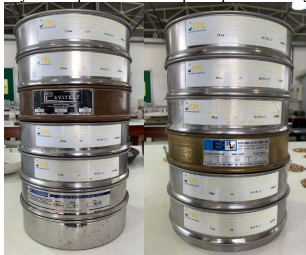
Figura 6 - Conjuntos de peneiras utilizado para o peneiramento grosso e fino
