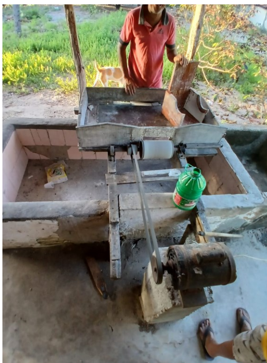
Imagem 25: Ralador/Triturador, substituído pelo ralador da imagem 15.
