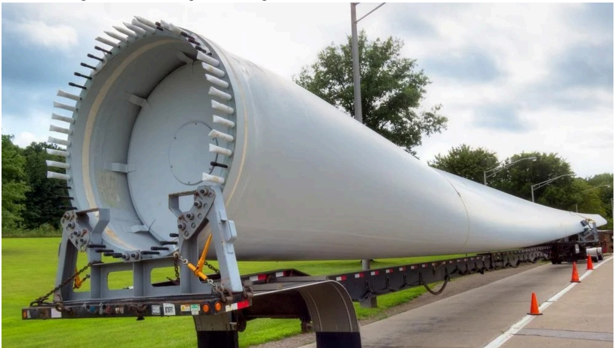
Figura 2 – Vista de pá eólica e pinos conectores em sua base.
