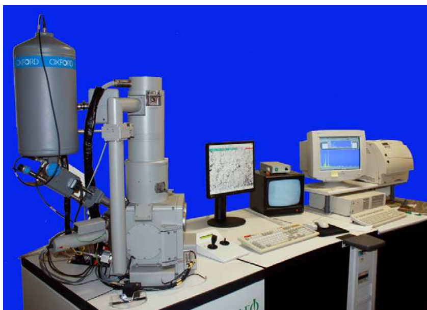
Figura 6. Espectrômetro de energia dispersiva por raio-X acoplado ao microscópio eletrônico de varredura.
