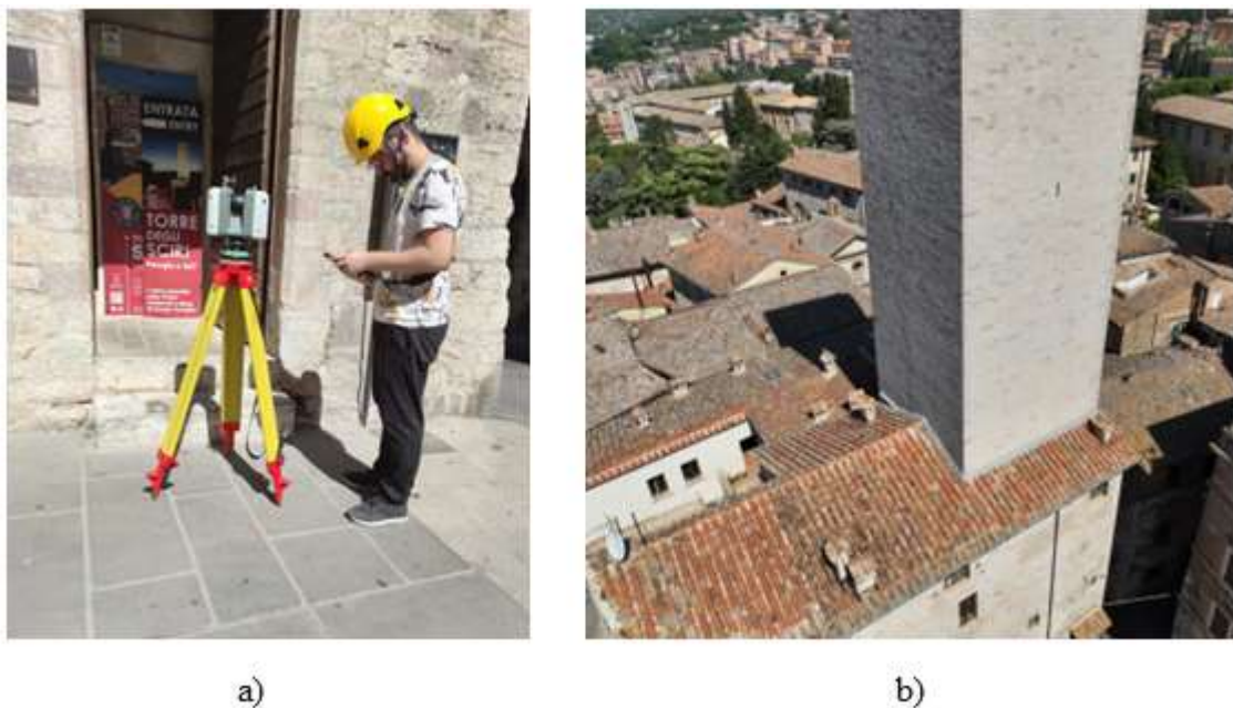
Figura 42 – Processo de captura da nuvem de pontos: a) Levantamento utilizando scanner terrestre RTC360; b) Fotogrametria via drone
