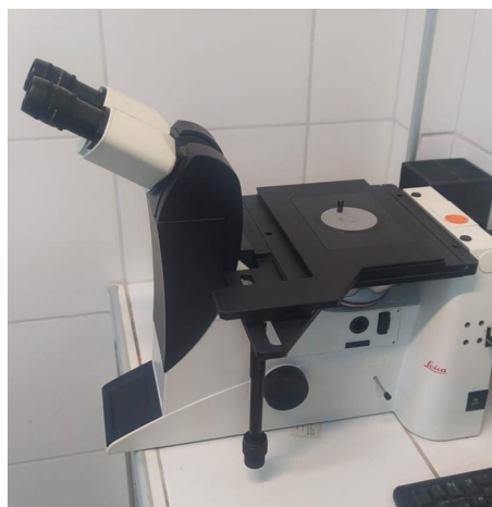
Figura 13 – Microscópio óptico de modelo DMI3000 M utilizado no estudo.
