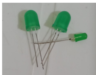
Figura V — Lâmpadas de led de 3 volts
