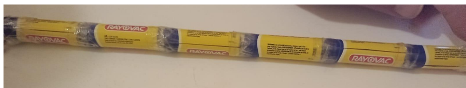
Figura XV: Associação em série de 6 pilhas de 1,5 volts cada.
