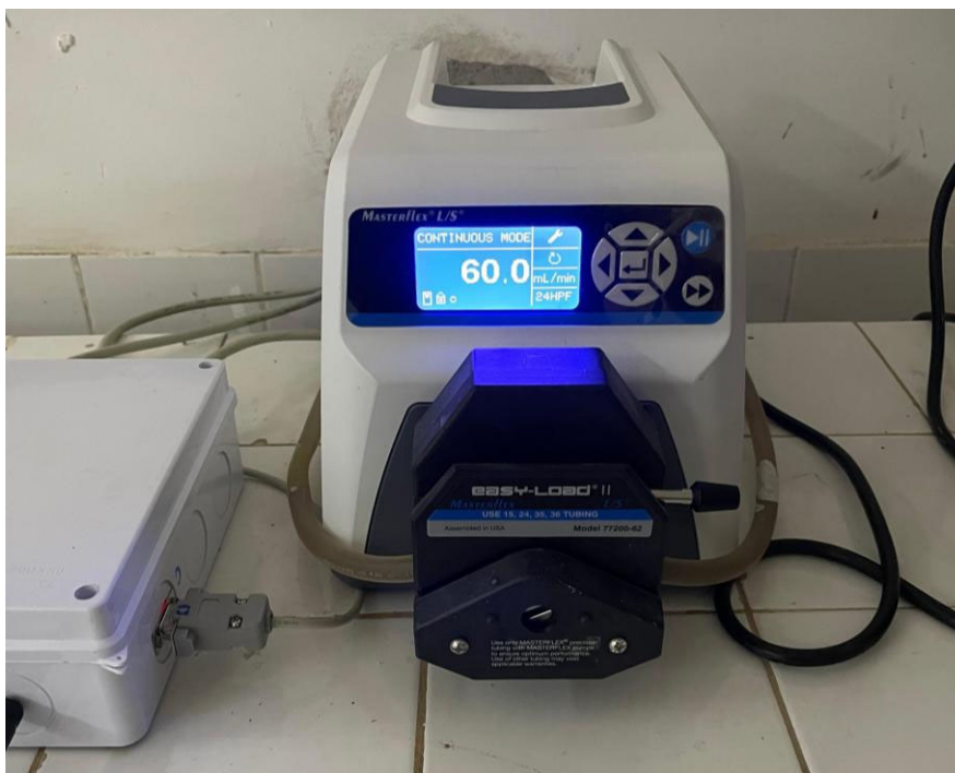
Figura 10 – bomba peristáltica utilizada na alimentação do reator
