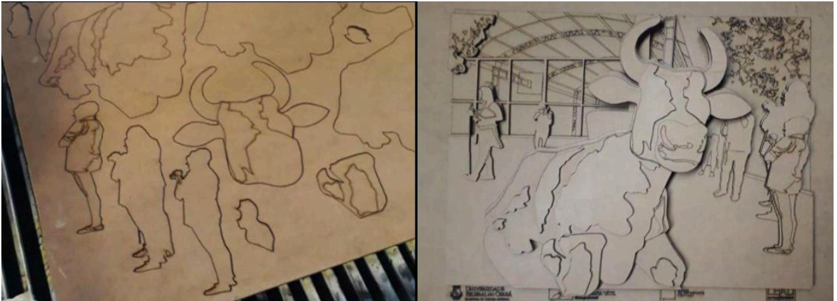
Figura 13 - Camadas para construção da peça e peça tátil finalizada de MDF
