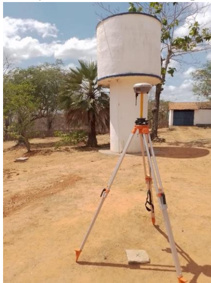
Figura 08: Instalação da Base em um novo ponto de coordenadas.
