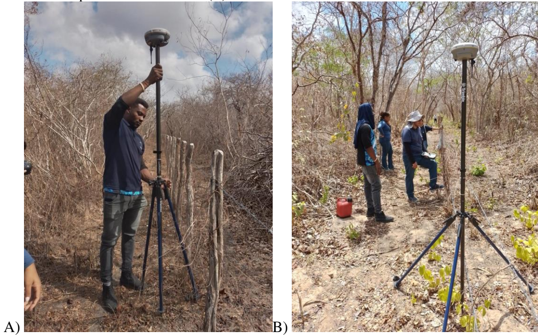
Figura 07: (A) Instalação do Rover (Estação Móvel), já em coleta, em um trecho do perímetro da fazenda. (B) Rover coletando os dados.
