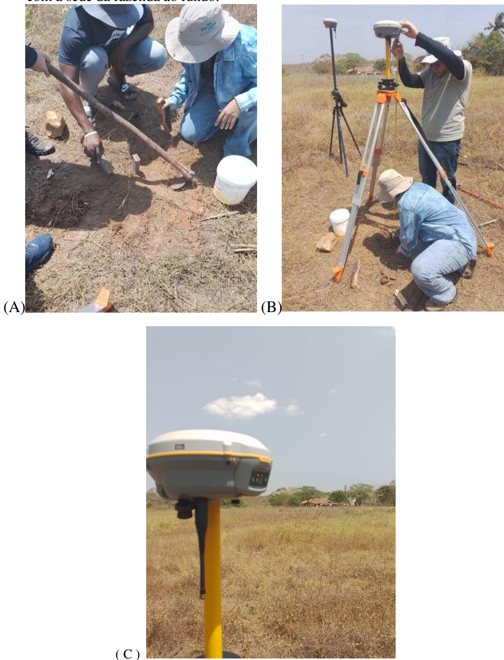
Figura 05: (A) Marcação do ponto para instalação da Estação Base, com o auxílio de um piquete. (B) Medição da altura que a Estação Base ficou em relação ao ponto marcado. (C) A Estação-Base já instalada, captando os sinais dos satélites com a sede da fazenda ao fundo.
