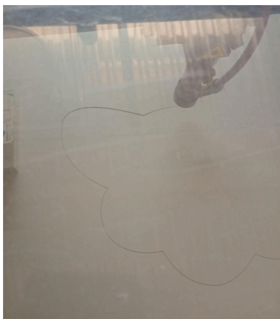
Figura 59 - Processo de Corte a laser em PVC.
