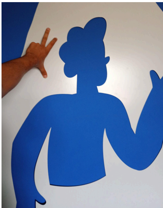
Figura 60 - Molde de Stencil pela corte a laser em PVC.
