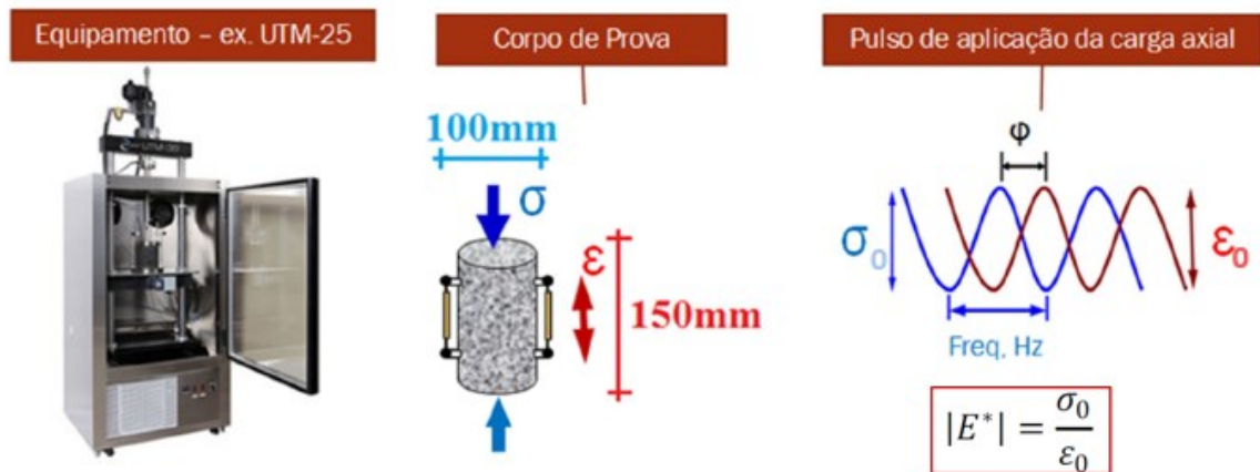
Figura 1 – Ensaio de módulo complexo
