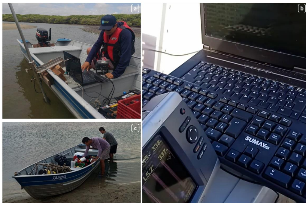
Figura 5 - Conjunto de equipamentos para aquisição de dados de geofísica subaquática a bordo da lancha “Tainha”; b) Ecossonda, vista frontal, com transectos orientando a rota para captura de dados; c) Embarcação “Tainha” de propriedade do LABOMAR/UFC.
