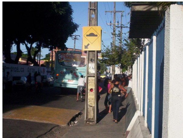
Fig. 77 – Recuo insuficiente, problema acentuado ainda mais pela parada de ônibus colocada no local. Fonte: Acervo.
