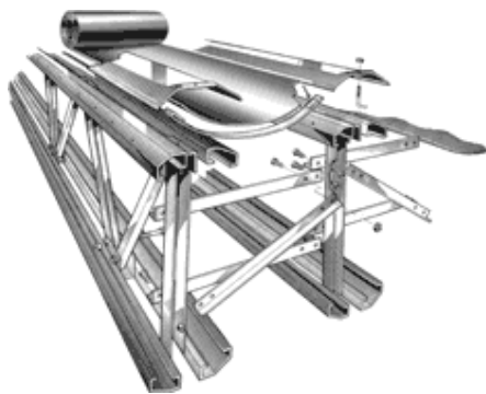
Figura 26-Esquema estrutural da cobertura Roll-on(FONTE: site Marko )
