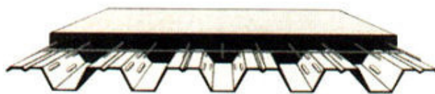
Figura 25-Esquema estrutural da laje steel deck
