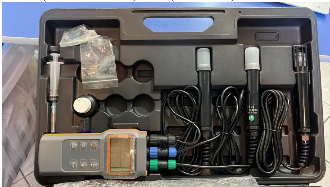
Figura 20 – Apresentação da sonda multiparâmetros Akso AK88 utilizada a aferição de oxigênio dissolvido, temperatura, pH e salinidade em sistema aquapônico para produção de tilápia do Nilo ( Oreochromis niloticus ) e alface ( Lactuca sativa ).
