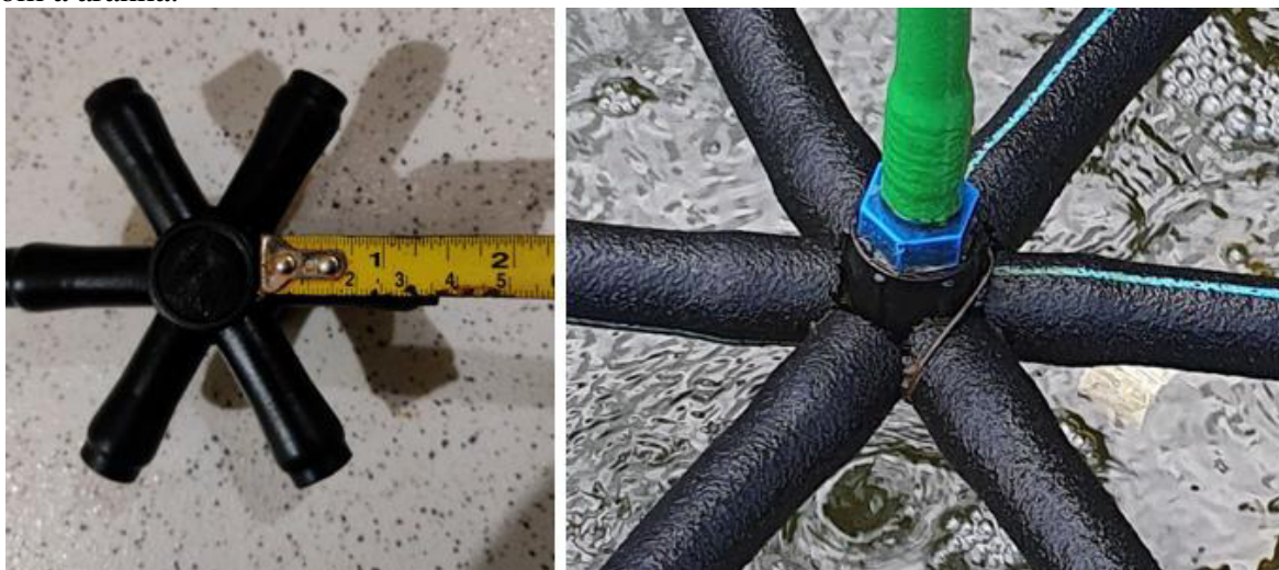
Figura 19 – Representação do comprimento perdido de mangueira porosa devido à conexão com a aranha.
