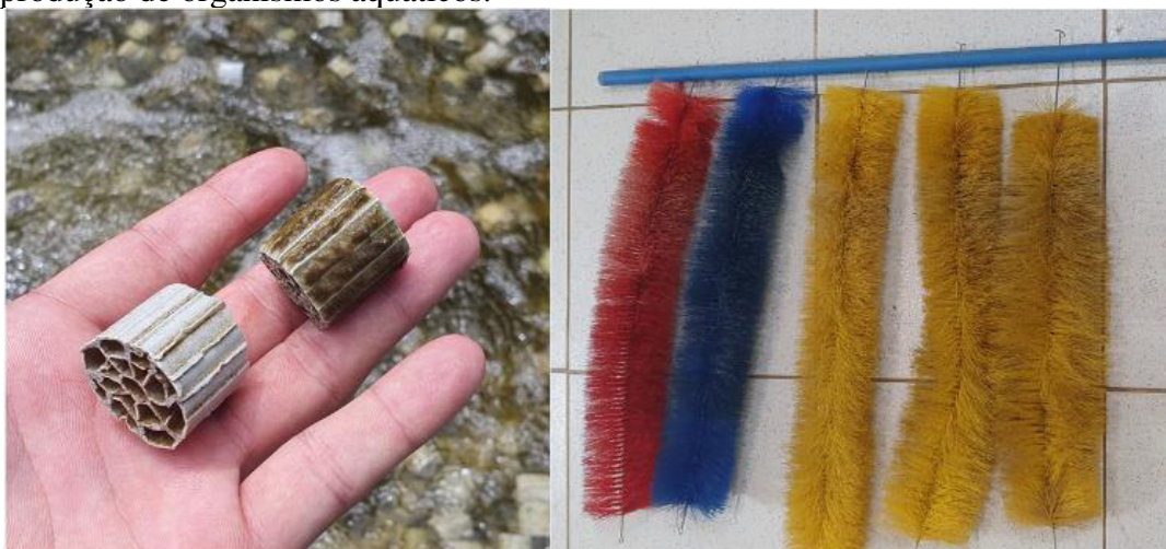
Figura 18 – Mídias biológicas e Escovas filtrantes utilizadas em sistema de tratamento de água para produção de organismos aquáticos.
