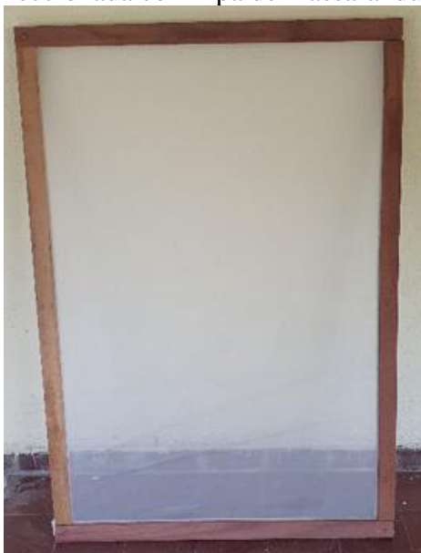
Figura 15 – Tela filtrante confeccionada com ripa de massaranduba.
