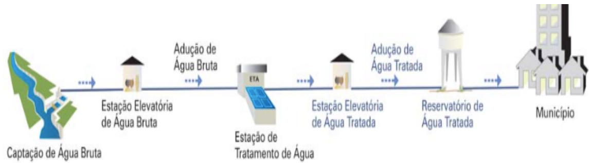
Figura 4: Esquema típico de Sistema de Abastecimento de Água em zona Urbana.
