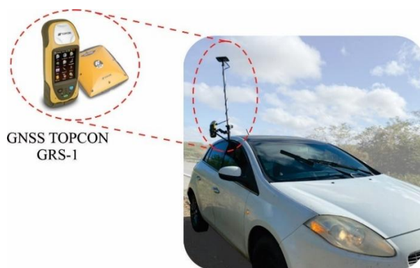
Figura 46 - GNSS TOPCON GRS-1 acoplado ao veículo.
