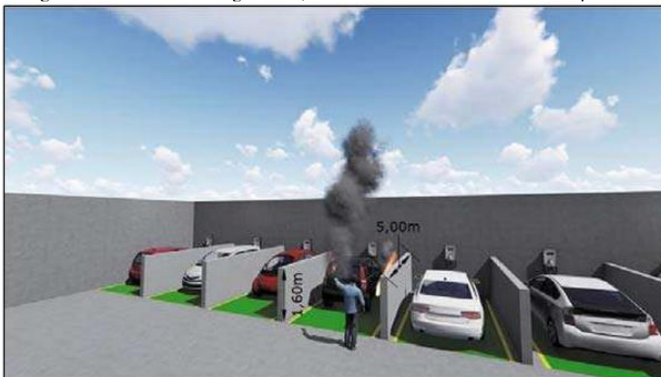
Figura 40 - Paredes corta fogo com 1,6 metros de altura e 5 metros de comprimento
