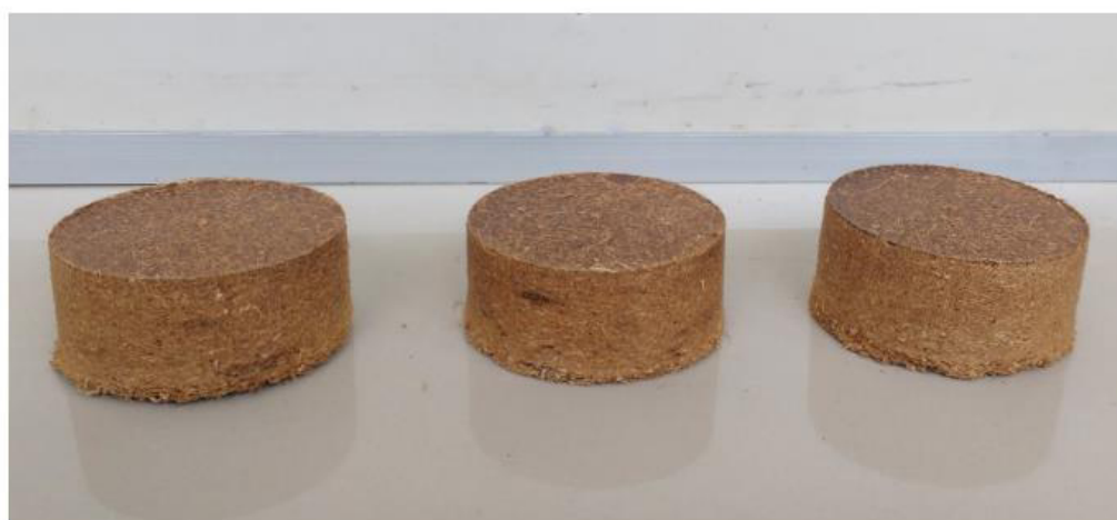
Figura 3 – Briquetes de cascas de coco-verde. Rio Largo, AL, 2020.
