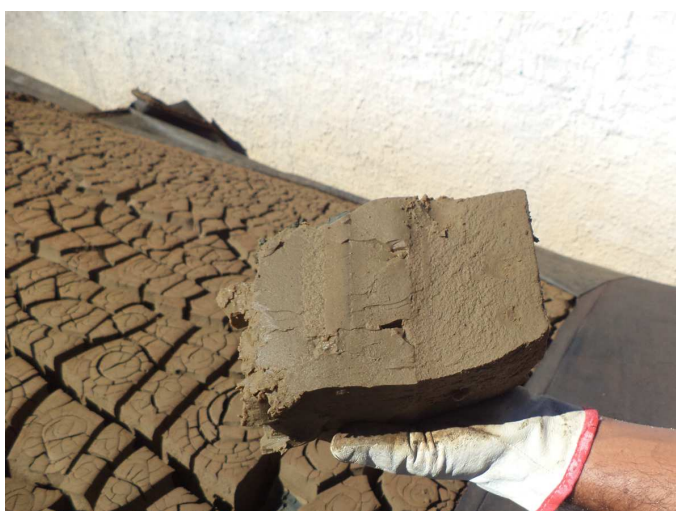
Figura 18 - Torta de lodo proveniente do processo de tratamento de água
