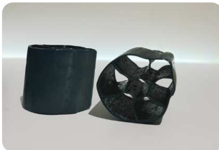
Figura 11: Exemplo do meio suporte presente no filtro aerado submerso
