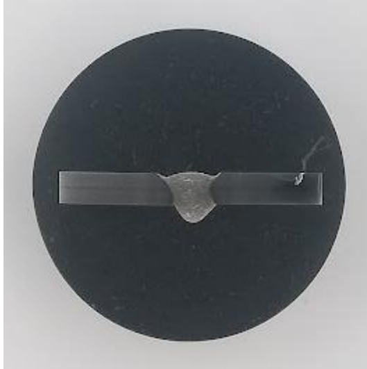
Figura 34 – Amostra após finalização da preparação metalográfica
