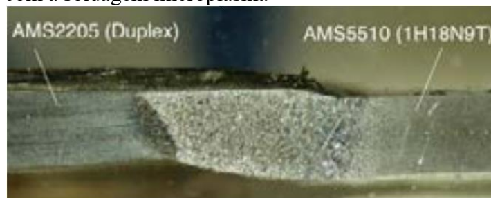
Figura 7 – Exemplo de junta produzida em chapa fina com a soldagem microplasma
