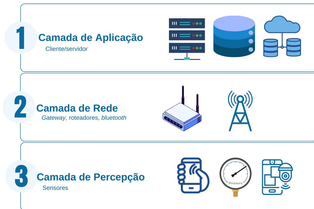
Figura 4 – Arquitetura de três camadas IoT
