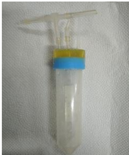
Figura 6 - Separadores gás-líquido (GLS): (A) Separador labmade; (B) Separador de filme fino
