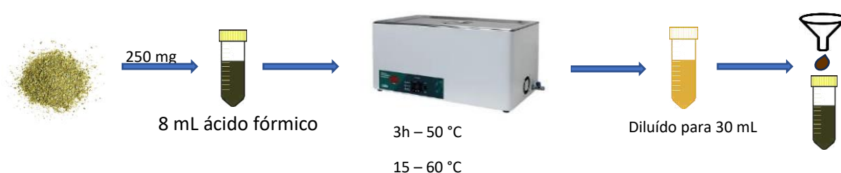
Figura 3 - Procedimento de preparo de amostra para PVG-AAS
