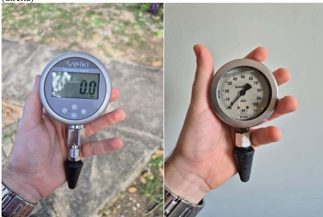
Figura 37- Manômetros utilizados nas medições: digital (esquerda) e analógico (direita)
