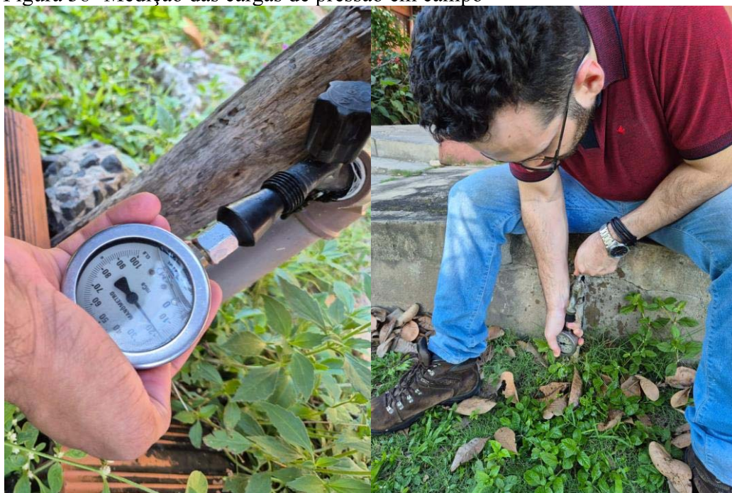
Figura 38- Medição das cargas de pressão em campo
