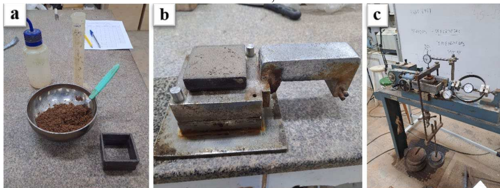
Figura 14 – Processos para ensaio de cisalhamento direto: a) Adição de água para atingi a umidade ótima da amostra; b) Moldagem do material; c) Prensa para ensaio de cisalhamento direto;
