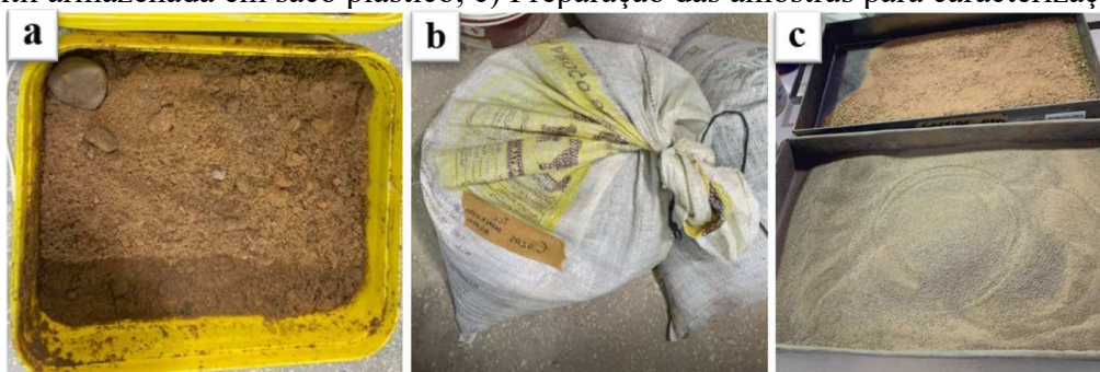
Figura 9 – Armazenagem e tratamento das amostras: a) Solo arenoso armazenado; b) Cinza têxtil armazenada em saco plástico; c) Preparação das amostras para caracterizações.
