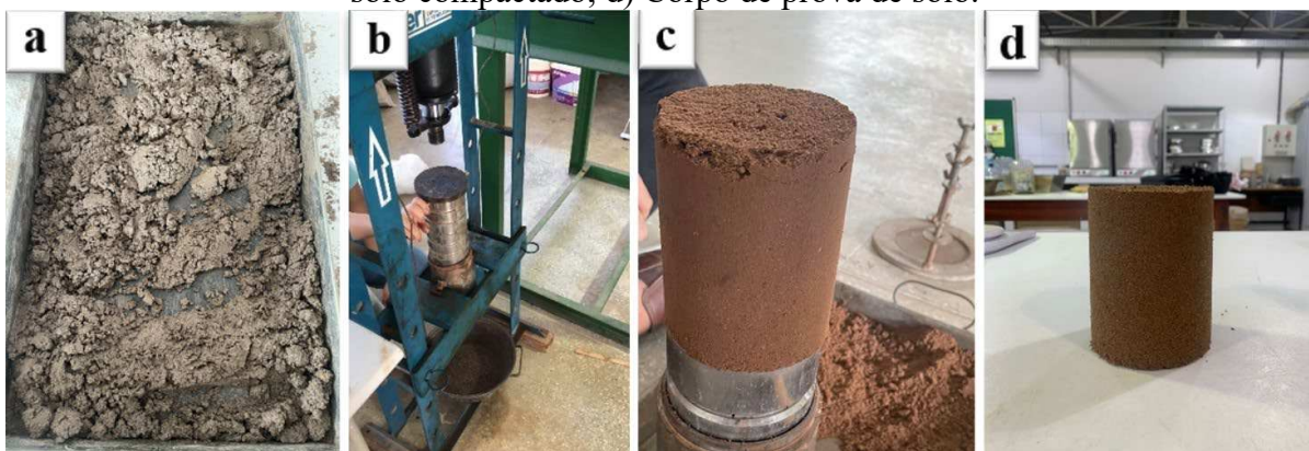
Figura 13 – Representação das fases do ensaio de compactação: a) Adição de umidade na amostra de cinza; b) Prensa para remover corpo de prova compactado; c) Corpo de prova de solo compactado; d) Corpo de prova de solo.
