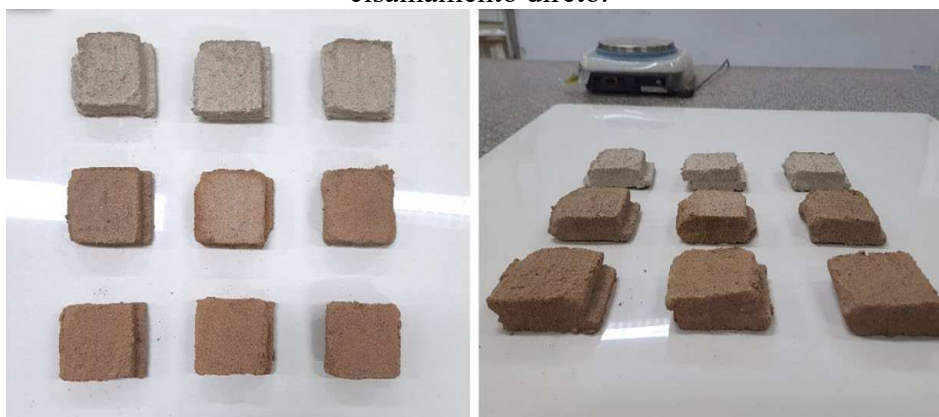
Figura 15 – Representação das amostras de cinza têxtil, mistura e solo após ensaio de cisalhamento direto.
